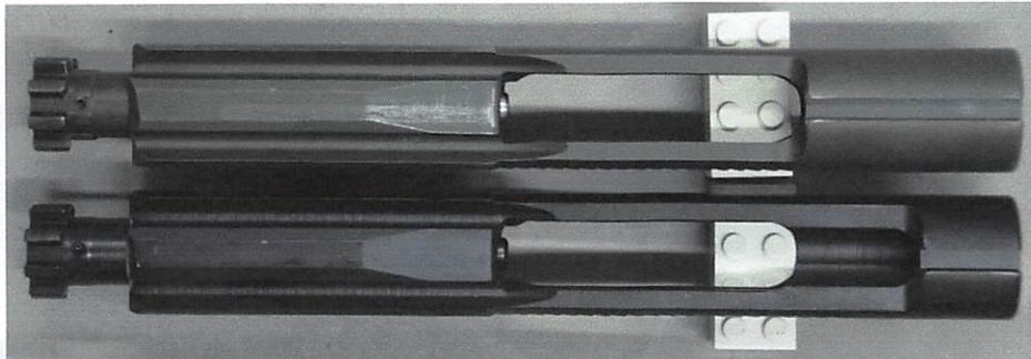
Abbildung 6: oben: Verschlussträger Colt AR15, unten: Verschlussträger DAR-15, mit Ausfräsung rechts
