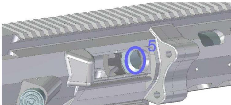
6. Wenn sich keine Patrone im Patronenlager befindet, kann der Verschlussfanghebel betätigt werden, woraufhin der Verschluss nach vorne schnellt und verriegelt.
