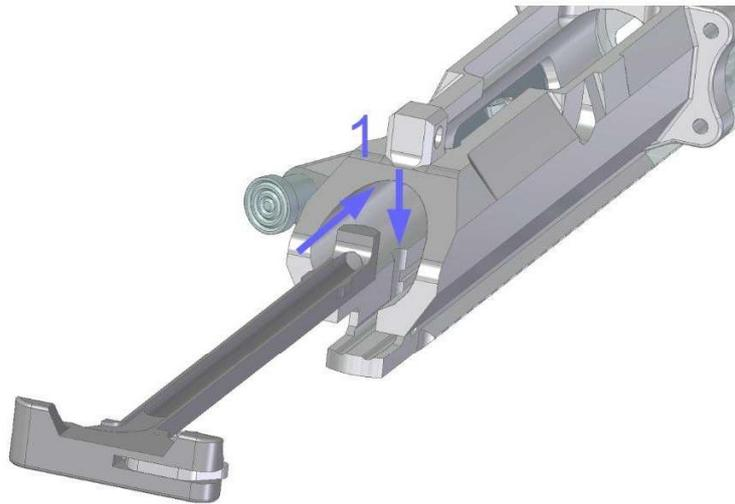
2. Den Verschluss einsetzen und zusammen mit dem Ladehebel nach vorne schieben bis sie einrasten.
