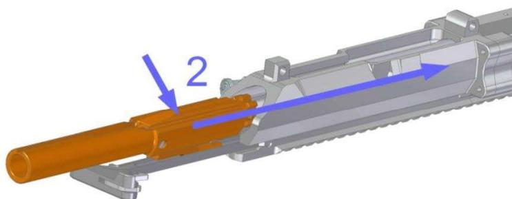
3. Die Staubschutzklappe schließen.
