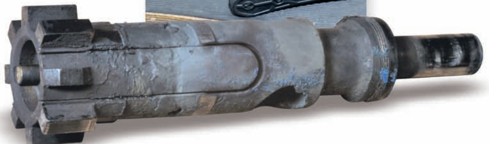
Hier war Schmutz gewollt: Im Dauertest über 1500 Schuss ohne Reinigung schlug sich eins der drei Gewehre mit Bravour – die Verschmutzung des Verschlusskopfes ist gut sichtbar, hat aber die Funktion nicht beeinflusst. Insgesamt darf man auf die Qualität der Serienfertigung bei den DAR-Gewehren gespannt sein.
