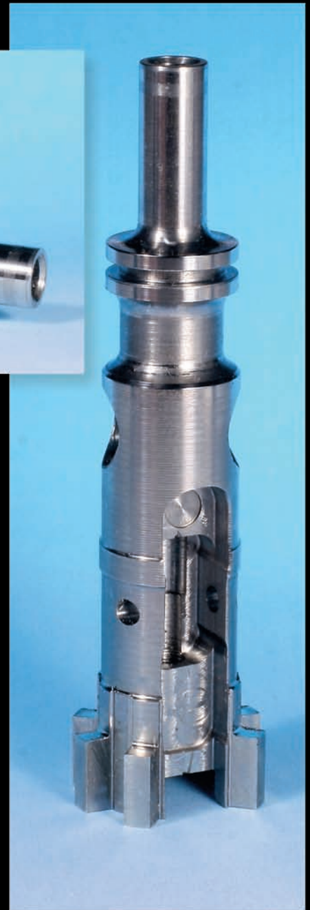
Ein noch nicht nitrierter D.A.R.-Verschlußkopf aus Vergütungsstahl 42CroMo4.
